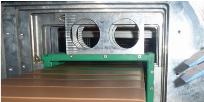
Плавнаонастраиваемое устройство для снятия фаски в резчике ротационного действия Continuously adjustable chamfering device in the rotary cutter
