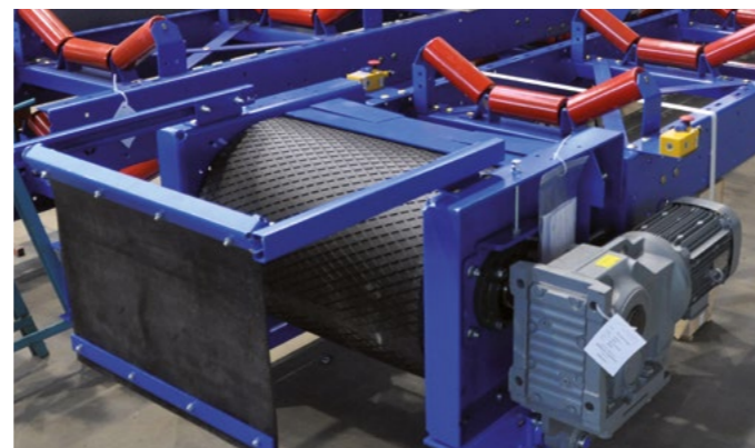
Приводная станция с насадным мотор-редуктором и прорезиненным приводным барабаном Driving station with slip-on geared motor and rubberized drive pulley
