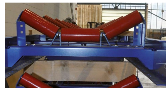
Роликовая опора с наклоном в 30 градусов Roller chair with 30 degree gradient
