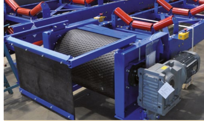
Station d'entraînement avec réducteur à arbre creux et tambour d'entraînement caoutchouté
