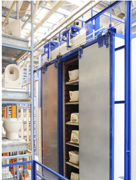
Trocknerausfahrt Dryer exit
