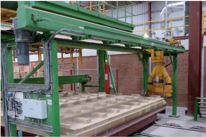
Overall View Suction Roof Tile Car общий вид системы аспирации вагонетки для черепицы
