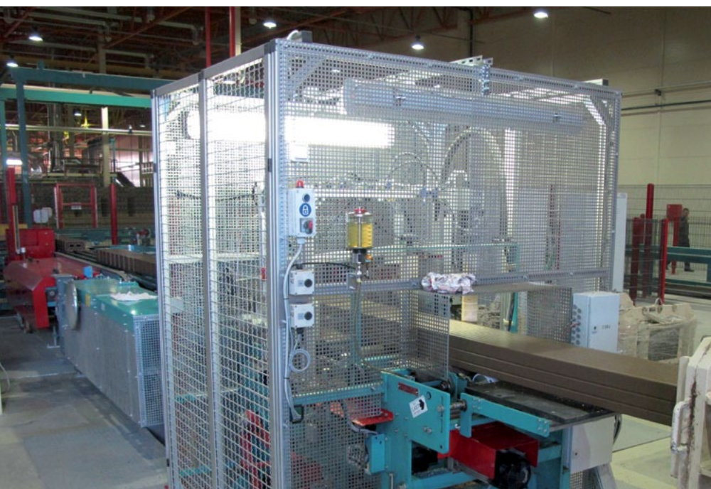
LINGL bi-directional cutter Двунаправленный обрезчик по системе ЛИНГЛ
