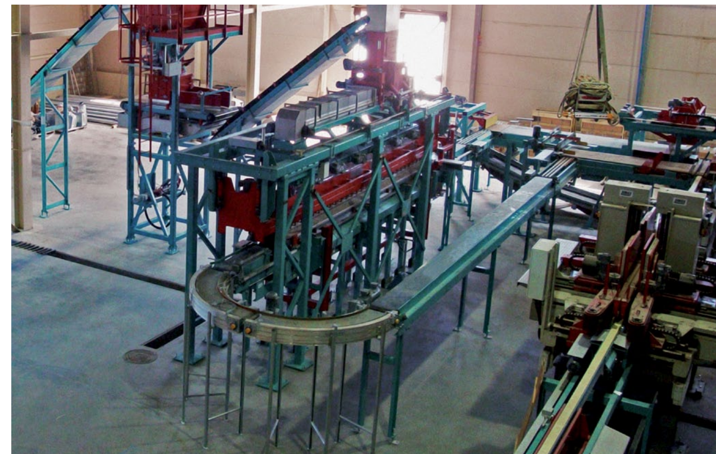
Grinding and filling installation установка шлифования и наполнения кирпича
