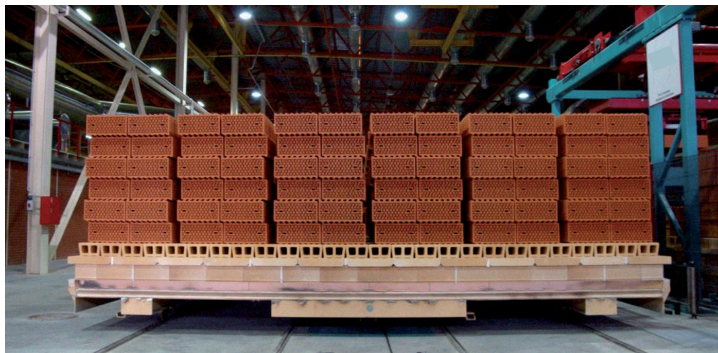
Kiln cars with fired large-size blocks печные вагонетки с обожженными крупноформатными блоками
