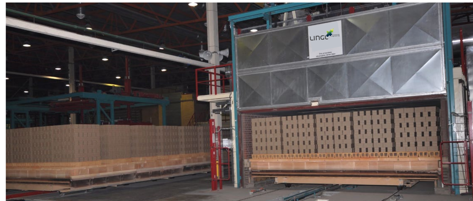
Tunnel Kiln Entrance въезд в туннельную печь
