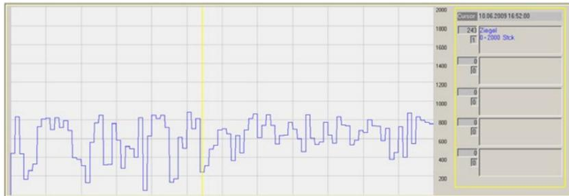
Das Ergebnis aller Zählfunktionen, ergänzt durch errechnete Werte (Tonnage, Maschinenleistung, usw.), wird als Viertelstundengrafik angezeigt und in Schichtprotokollen auf der Datenbank des Systems gespeichert.
