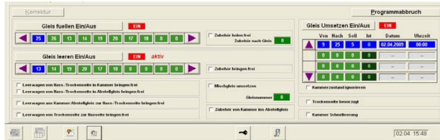
Zur Steuerung der Kammertrocknerbühne steht ein Prozessbild zur Verfügung, in welchem die Reihenfolgen für das Leeren und Füllen der Gleise vorgegeben werden können.
