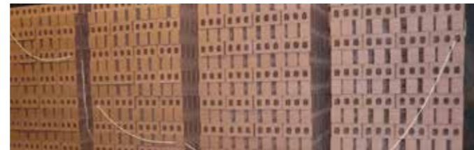
Замер с использованием регистратора Datapaq Datapaq-Messung beim Kunden
