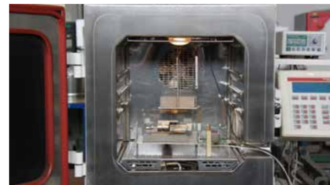
Определение свойств при сушке посредством климатического шкафа Bestimmung des Trockenverhaltens im Klimaschrank
