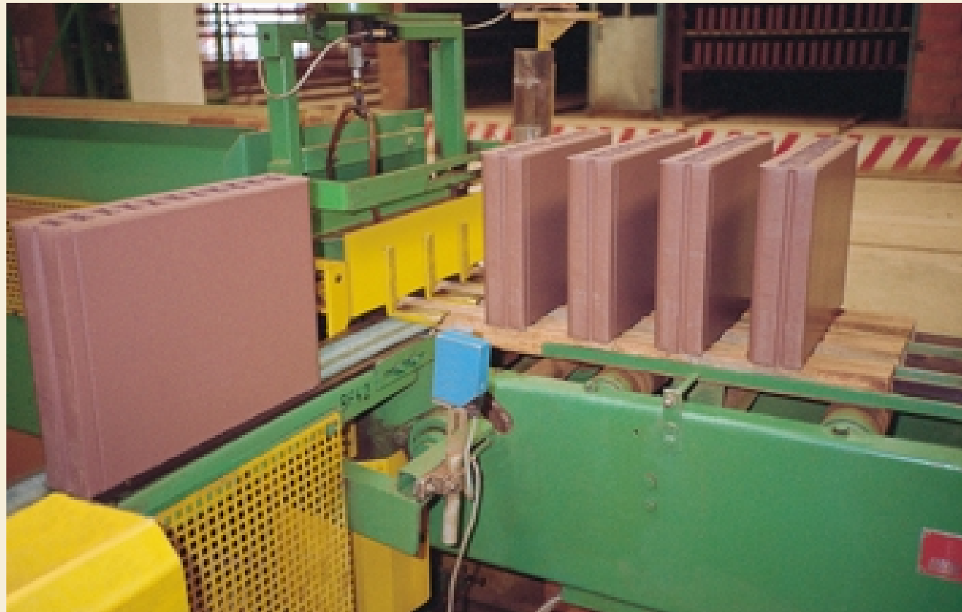
▼ Treppenstufen-Doppelplatten werden auf die Formlingsträger abgesetzt
