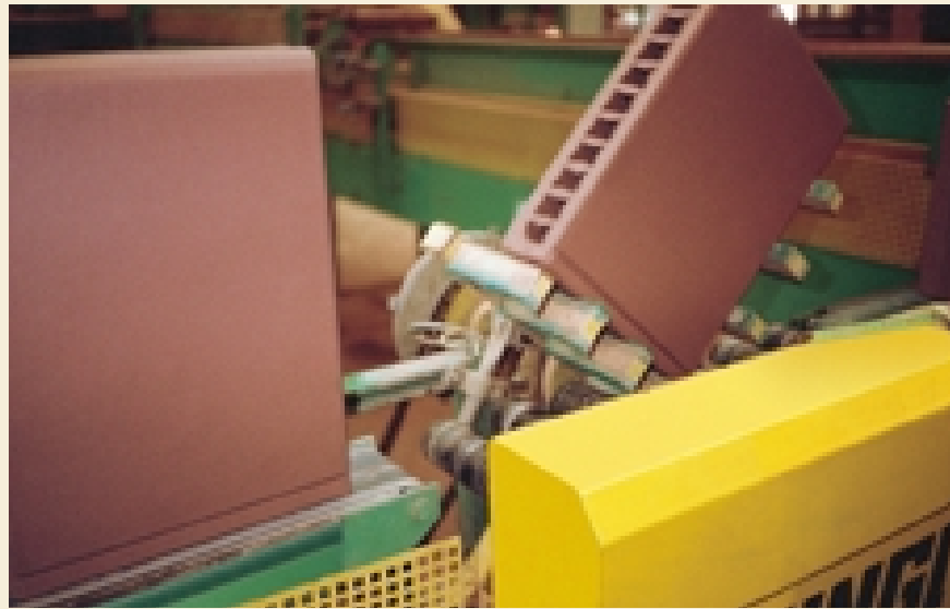
▲ Kippen der Formlinge nach dem Schneiden. Treppenstufen, Eckplatten und Platten für ähnliche Zwecke werden nach dem Schneiden, in Vorbereitung für das spätere Setzen auf den Ofenwagen, gekippt.
