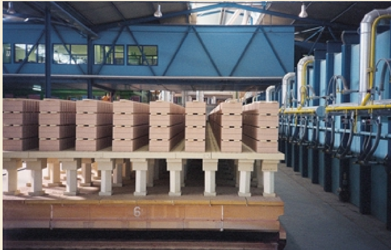
▼ Tunnelofenwagen mit Sockelleisten, Lingl-Tunnelofen mit Seitenbrennanlage
