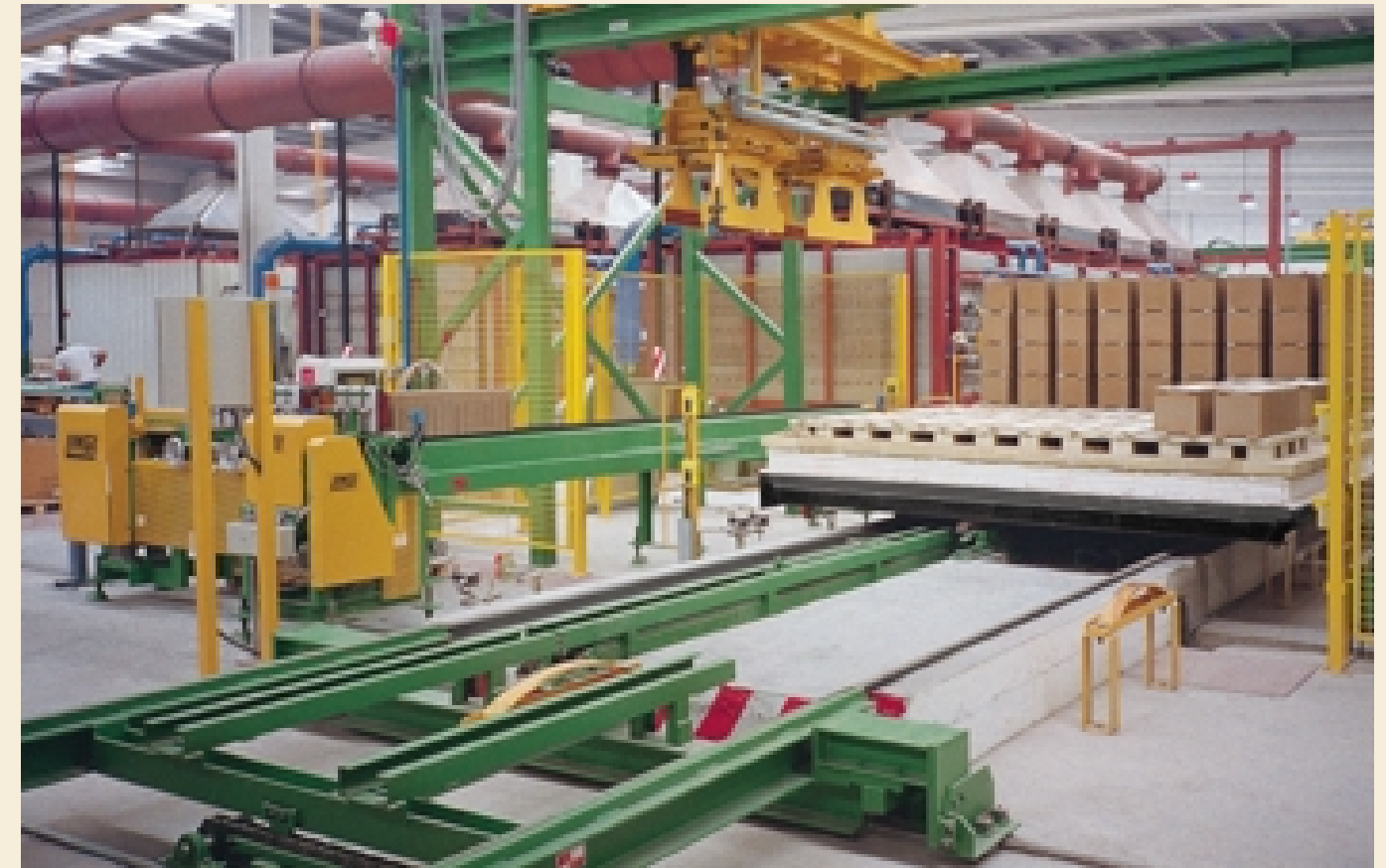
▲ Spaltplatten werden in Reihen vom Ofenwagen entladen, vereinzelt und der Trennanlage zugeführt
