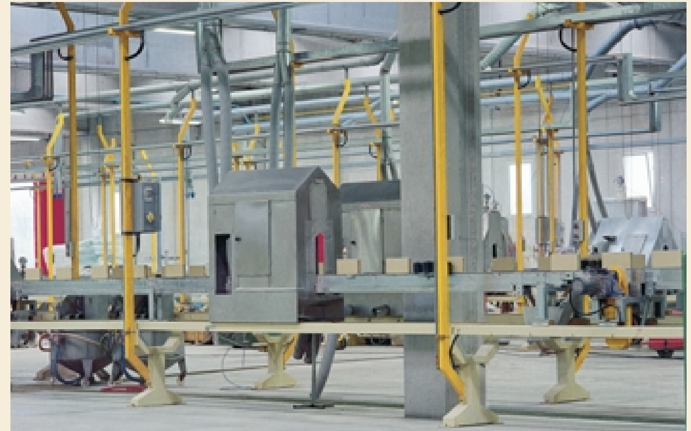
▼ Mehrlinige Glasierstationen für beidseitiges Trockenglasieren mit dem Lingl-Schleuderverfahren für hochwertige Glasuren, auch mit speziellen Farbeffekten und unterschiedlichen Deckschichten. In Kombination mit Druckluft-Spritzsystemen und Spezialantrieben können besondere Schattierungseffekte erzeugt und auch die anspruchsvollsten Glasuranforderungen gelöst werden.
