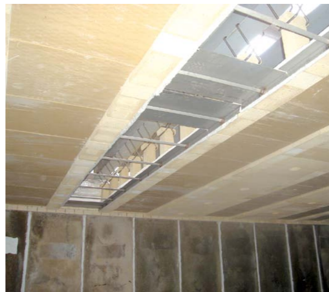
Modulofen – Feuerfestauskleidung Wand und Decke Modular kiln – wall and roof refractory lining
