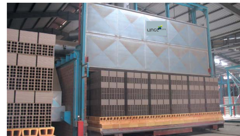
Tunnelofen für Langlochziegel Tunnel kiln for hollow ware
