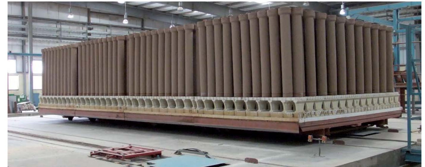
Tunnelofenwagen mit Steinzeugröhren Tunnel kiln car with vitrified clay pipes
