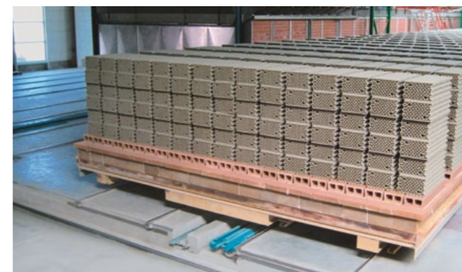
Modular tunnel kiln for porous back-up wall blocks Four tunnel en construction modulaire pour briques poreuses de remplissage
