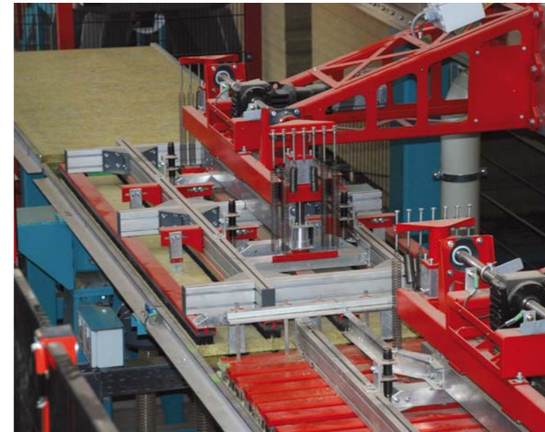
Mineralwoll-Portalgreifer im Bereich der Sägelinie Mineral wool gantry gripper in the saw line area
