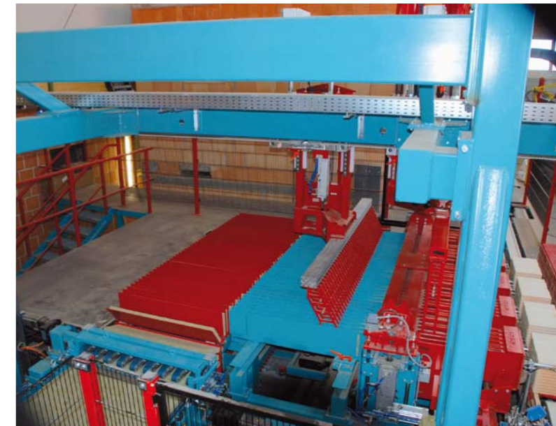
Mineralwollpad-Aufstellfächer, Einschieberbalken und Vorziegel Mineral wool tilting device, pusher fork and pre-brick mould
