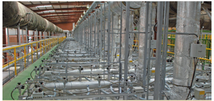
Four tunnel LINGL avec chauffage en voûte LINGL tunnel kiln with top firing
