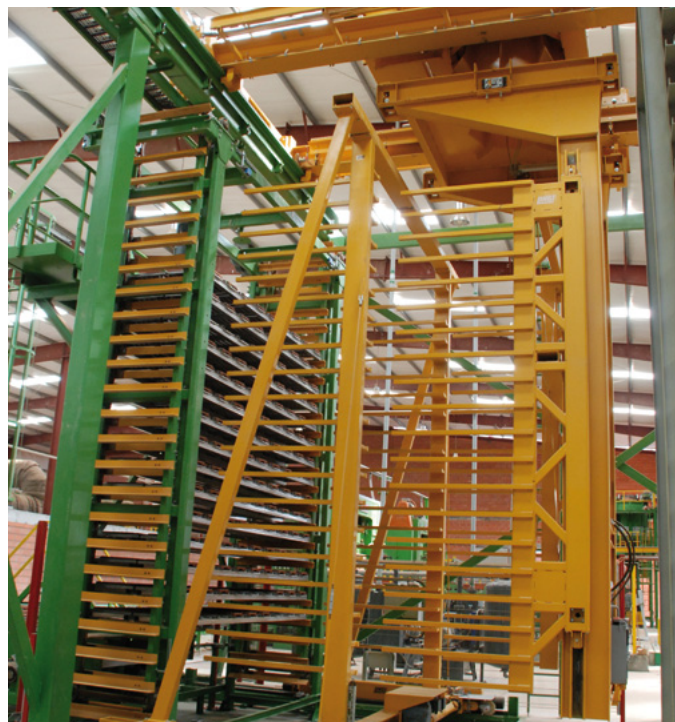
Râtelier pour chargement et déchargement des chariots de séchoir Loading rake for loading and unloading of dryer cars
